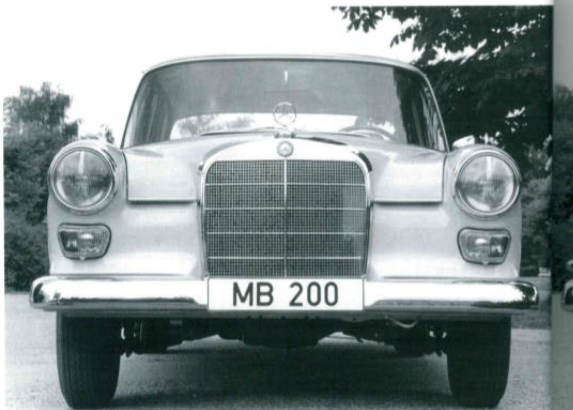
Továbbfejlesztés: 200-asként az autónak már kombinált irányjelzőjük, parkoló és ködlámpájuk volt
